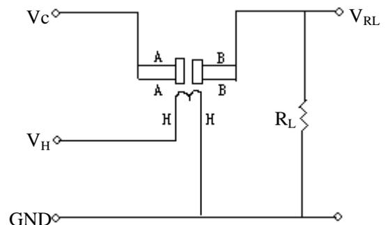
上图是传感器的基本测试电路。该传感器需要施加2个电压: 加热器电压(V<sub>H</sub>)和测试电压(V<sub>c</sub>)。其中 V<sub>H</sub>用于为传感器提供特定的工作温度。V<sub>c</sub>则是用于测定与传感器串联的负载电阻(R<sub>L</sub>)上的电压(V<sub>m</sub>)。这种传感器具有轻微的极性, V<sub>c</sub>需用直流电源。在满足传感器电性能要求的前提下, V<sub>c</sub>和V<sub>H</sub>可以共用同一个电源电路。为更好利用传感器的性能,需要选择恰当的R<sub>L</sub>值。
